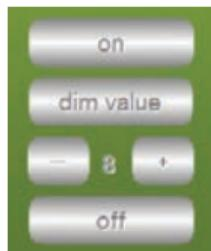
Vrednost prigušenja svetla menjate preko +/- tastera. "**dim value**" taster omogućava slanje određene vrednosti intenziteta svetlosti (1 do 16) dimeru, čime se omogućava podešavanje jačine svetlosti po želji. Za obične prijemnike se koriste **on** i **off** tasteri za uključivanje/isključivanje uređaja.
