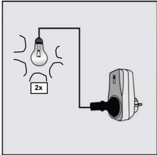
[5] Za potvrdu konekcije, H.A. utičnica će se upaliti/ugasiti dva puta. Kod(code) transmitera je memorisan u internoj memoriji H.A.utičnice i uređaj se spremam za korišćenje.
